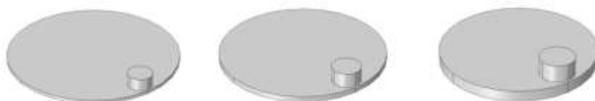
شکل ۳- تغییر ضخامت متناسب با شعاع دیسک در حالت حجم ثابت-جرم ثابت
