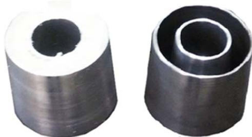
شکل ۴- نمونه‌های ساخته شده دوجداره توخالی و پر شده از فوم
