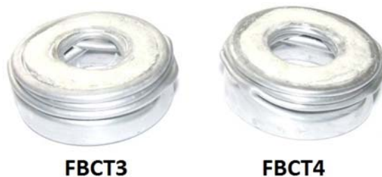
شکل ۸- فروریزش نمونه‌های دوجداره پر شده از فوم تحت بارگذاری محوری
