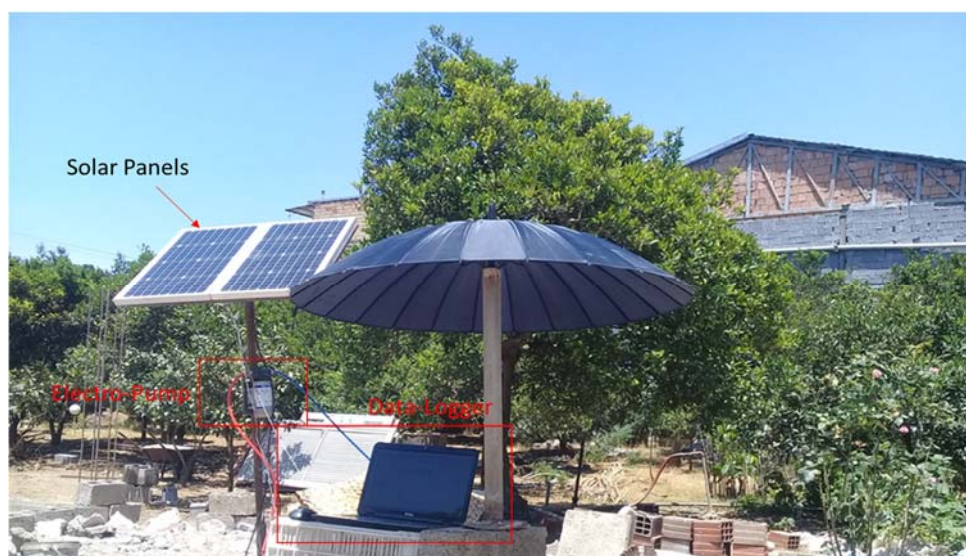
شکل ۳- تجهیزات و سیستم داده برداری استفاده شده در تست
