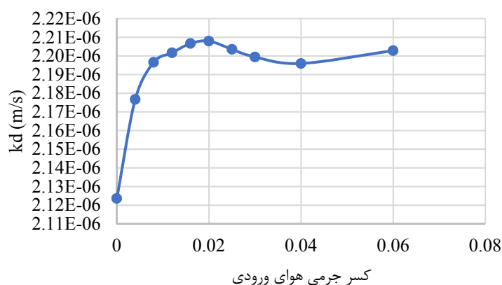
شکل ۸- تغییر ضریب انتقال جرم میانگین در مقابل کسر جرمی هوا در ورودی
