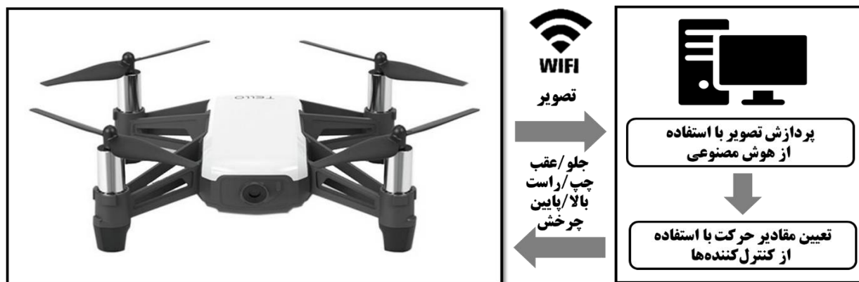
شکل ۱۱- نمایی از کوادکوپتر تلو و تبادل اطلاعات با رایانه
