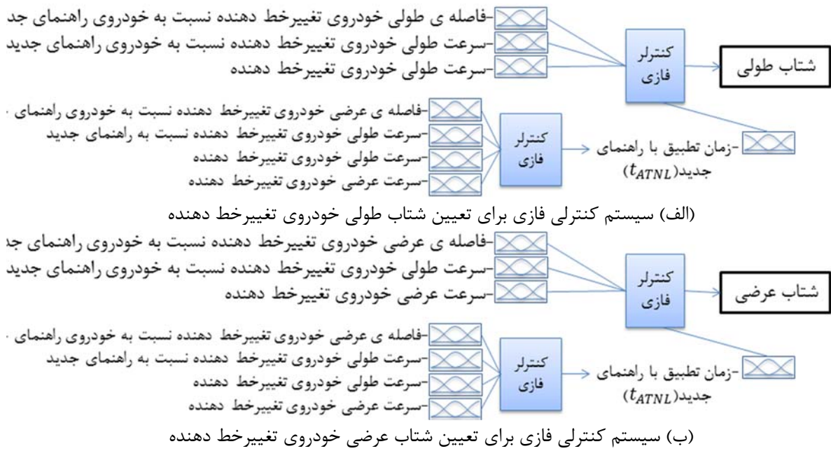
شکل ۷- ساختار سیستم کنترلی فازی در بازه‌ی زمانی تطبیق با راهنمای جدید
