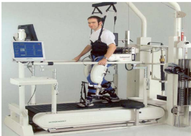
شکل ۱- دستگاه محصول شرکت هوکوما شامل یک اورتر گام و یک سیستم نگهدارنده وزن انسان ترکیب شده با یک تردمیل و یک سیستم واقعیت مجازی.
