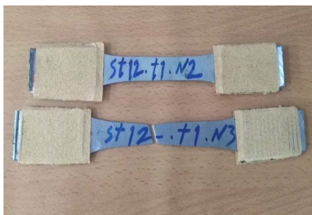
شکل ۲- نمونه‌های قبل و بعد از تست کشش برای تعیین مشخصات مکانیکی فولاد.
