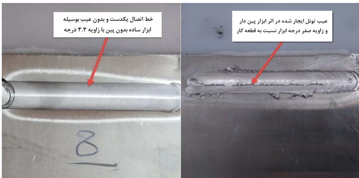
شکل ۸- اثر اصلاح ابزار و زاویه بر روی خط اتصال
