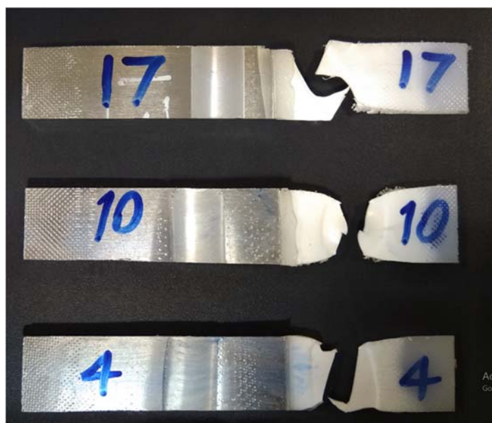
شکل ۱۹- شکست در نمونه‌های با استحکام اتصال بالا تحت بارگذاری دینامیکی
