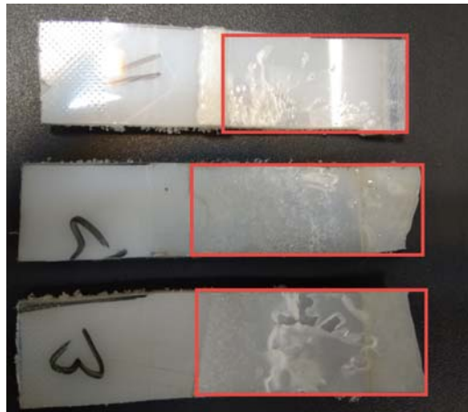
شکل ۱۶- حباب‌های شکل گرفته در فصل مشترک اتصال
