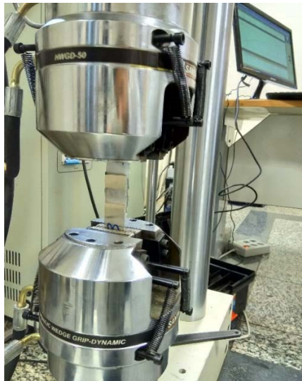
شکل ۶- نحوه انجام آزمایش تست کشش
