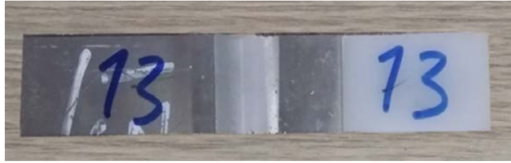
شکل ۵- نمونه جوش خورده به صورت استاندارد با عرض جوش ۲/۴mm و طول ۱۵۰mm
