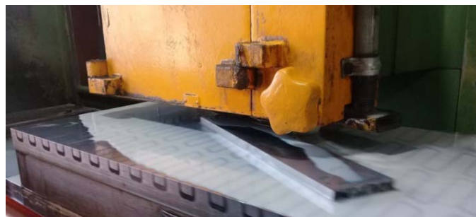
شکل ۳- صاف و صیقلی شدن سطح ستون توسط دستگاه سنگ‌زنی
