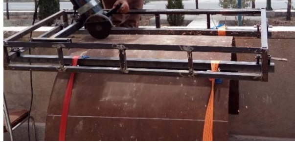
شکل ۱- برش لوله فولاد API X65 توسط دستگاه برش‌زن
