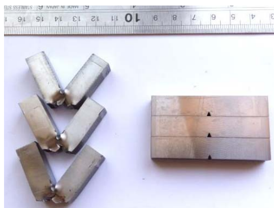
شکل ۱۱- یک گروه سه تایی (با عمق شیار استاندارد) از نمونه آزمایش ضربه شارپی قبل و بعد شکست.
