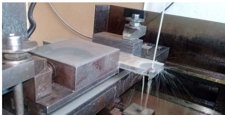
شکل ۴- ساخت نمونه‌ها با استفاده از دستگاه وایرکات
