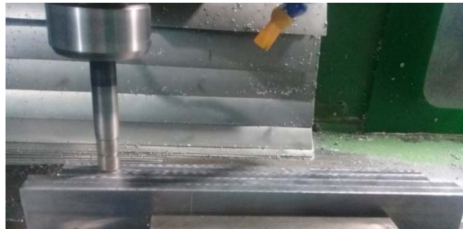
شکل ۲- حذف انحنا و کاهش عرض ستون با استفاده از دستگاه فرز
