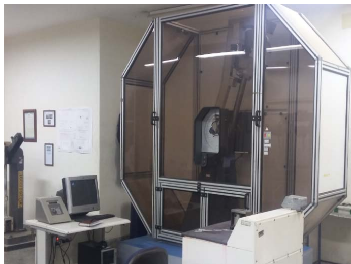
شکل ۶- ماشین ضربه شاریبی زوئیک رول آلمان با ظرفیت ۷۵۰ ژول
