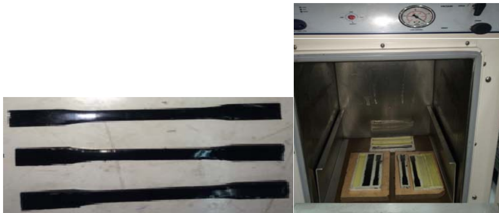
شکل ۵- آماده سازی نمونه‌های بدون الیاف برای تست کشش
