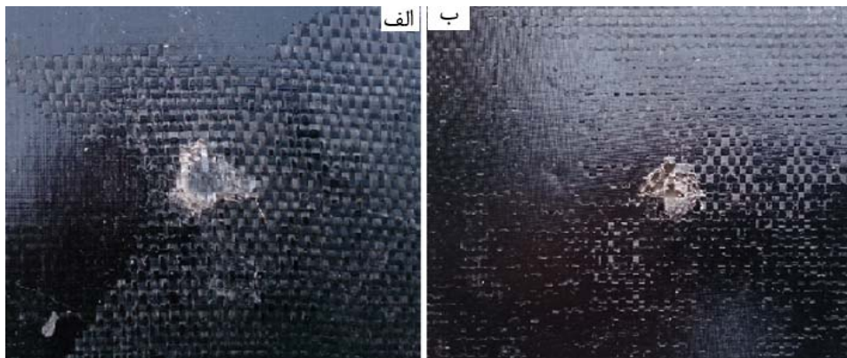
شکل ۱۷- الف) پلاگینگ ب) پتالینگ در کامپوزیت
