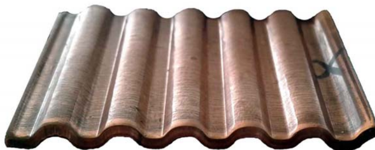
شکل ۱- نمونه مسی پس از یک پاس عملیات CGP
