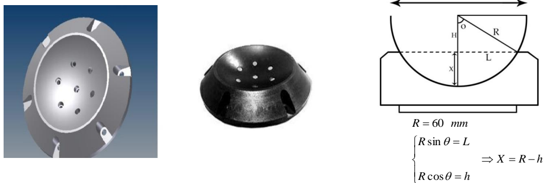
شکل ۴- کُنس داخلی یاتاقان هوایی شبیه ساز سخت افزار سه درجه آزادی ماهواره
