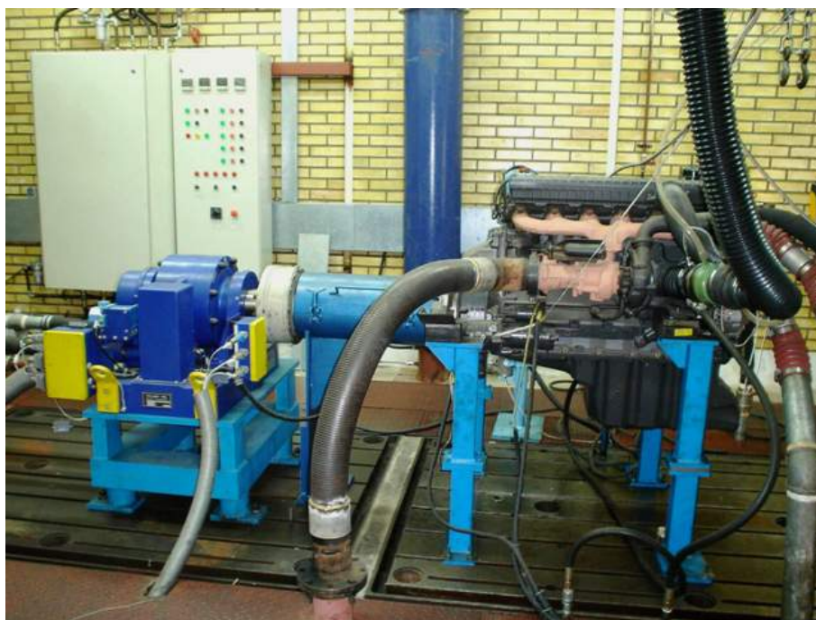
شکل ۱- سلول تست موتور دیزل مورد استفاده
