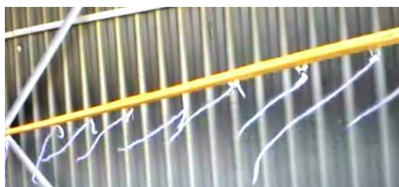
شکل ۱۰- الگوی جریان هوا در محل ۴ دلتای ۷۰
