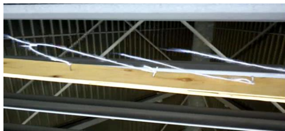
شکل ۱۲- الگوی جریان هوا در محل ۲ دلتای ۶۷
