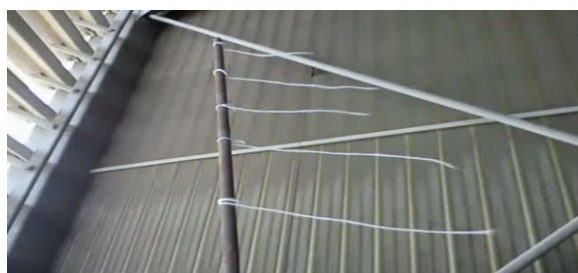
شکل ۱۳- الگوی جریان هوا در محل ۳ دلتای ۶۷
