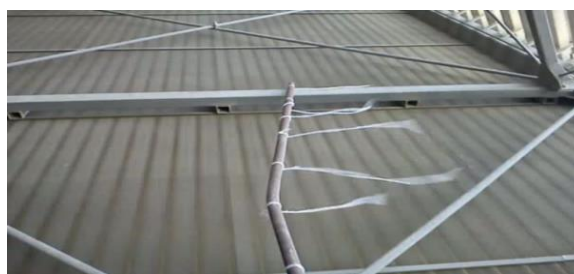
شکل ۱۴- الگوی جریان هوا در محل ۴ دلتای نامناسب
