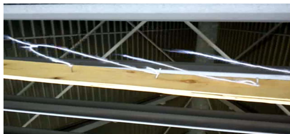
شکل ۱۲- الگوی جریان هوا در محل ۲ دلتای ۶۷
