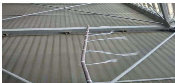
شکل ۱۴- الگوی جریان هوا در محل ۴ دلتای نامناسب
