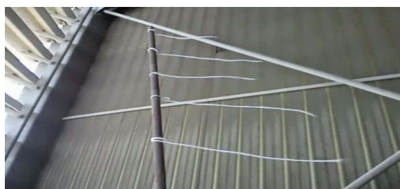
شکل ۱۳- الگوی جریان هوا در محل ۳ دلتای ۶۷
