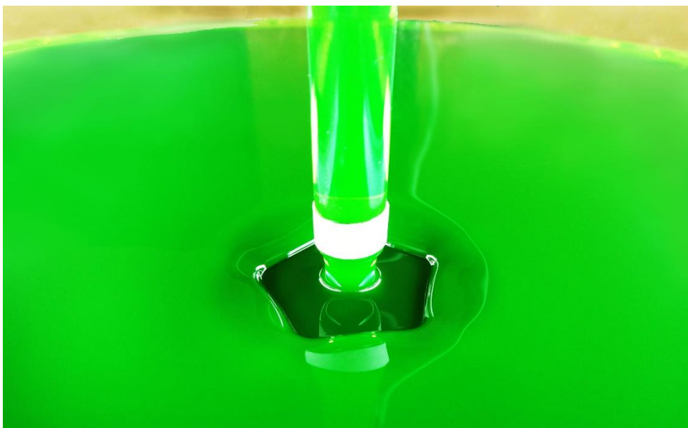
شکل ۳- نمونه‌ای از یک پرش هیدرولیکی پنج ضلعی پایدار؛ نوار سفید رنگ محل خروجی لوله شیشه‌ای را نشان می‌دهد.
