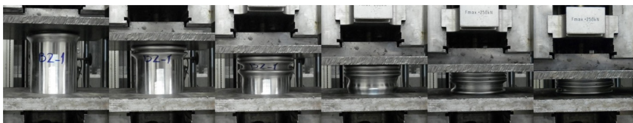
شکل ۶- مراحل فروریزش نمونه‌ی B2-1 در آزمایشگاه
