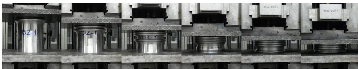
شکل ۶- مراحل فروریزش نمونه‌ی B2-1 در آزمایشگاه
