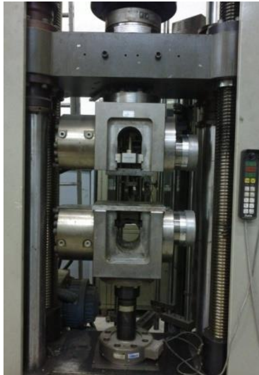
شکل ۴- دستگاه تست فشار مورد استفاده در آزمایش
