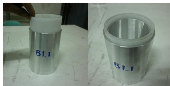
شکل ۵- ترکیب اصلی و نحوه‌ی هم‌محور قرار دادن لوله‌ها
