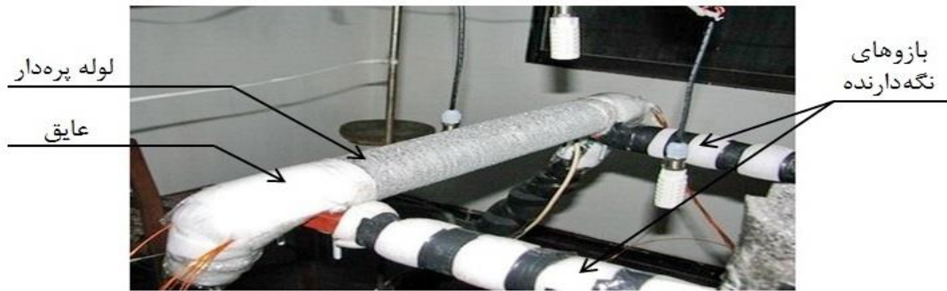
شکل ۳- نحوه قرارگیری لوله پره‌دار در اتاق کنترل
