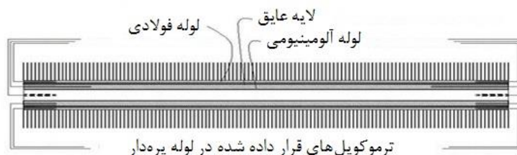
شکل ۵ - موقعیت ترموکوپل‌ها در قطعه آزمایش از نمای جانبی
