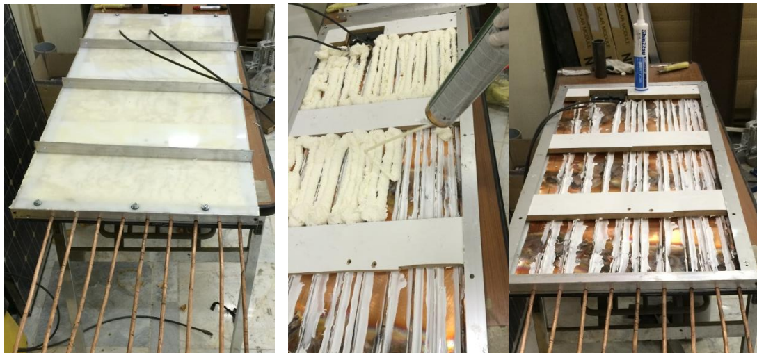
شکل ۶- پر کردن فضای خالی بین لوله های حرارتی و صفحه مسی (سمت راست) - عایق کردن لوله های حرارتی با استفاده از اسپری فوم (عکس وسط) - پوشاندن پشت پنل با استفاده از طلق اکریلیک (سمت چپ)
