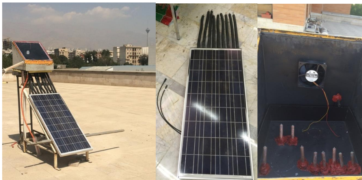
شکل ۷- اتصال مخزن آب به پنل خورشیدی و لوله های حرارتی از طریق چسب آکوارיום (سمت راست)- عایق کردن لوله های حرارتی با استفاده از فوم (عکس وسط) - شکل نهایی سیستم (سمت چپ)
