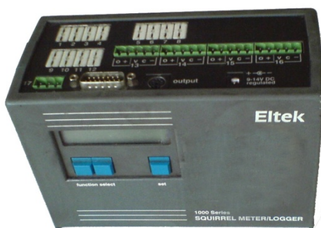
شکل ۲- دیتالاگر برای ثبت دماهای نقاط مختلف
