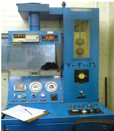
شکل ۱- بیرون اتاقک با ابزار کنترل دینامومتر
