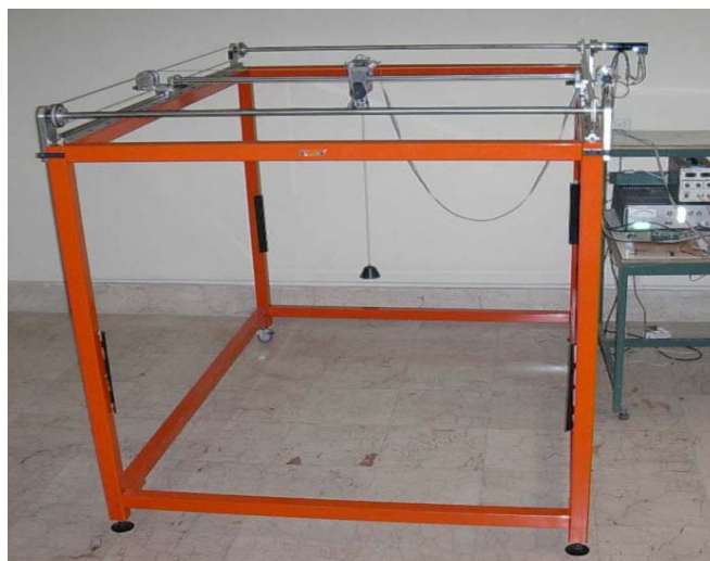
شکل ۹- مدل آزمایشگاهی جرثقیل سقفی ساخته شده در دانشگاه صنعتی امیرکبیر
