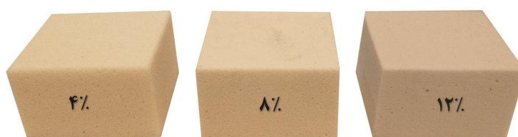
شکل ۵- نمونه‌های مختلف تهیه شده با نسبت چگالی‌های متفاوت برای انجام آزمایش‌های فشار تک محوری
