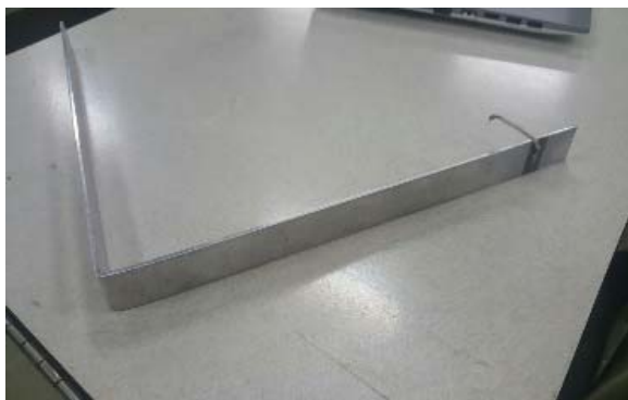
شکل ۲- قاب آلومینیومی و وصله پیزوالکتریک متصل شده روی آن
