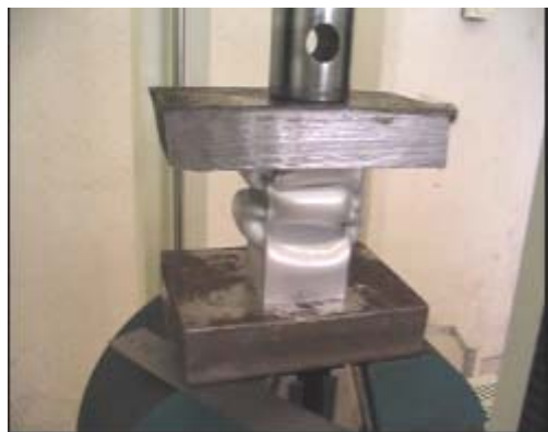
شکل ۳- دستگاه تست کشش- فشار (سازه‌های سلولی با مقطع مربع تحت بارگذاری فشاری در حالت مچالگی)
