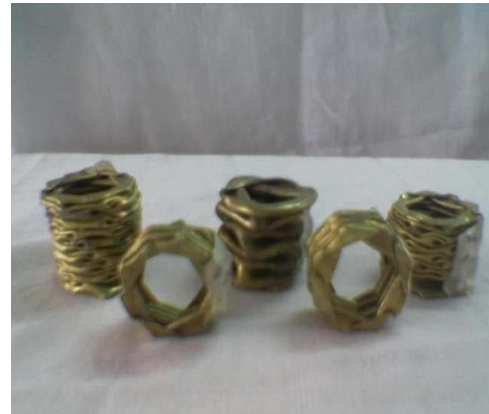
شکل ۴- نمونه های آزمایش شده سازه های استوانه ای از جنس برنج با تعداد تاخوردگی قابل ملاحظه
