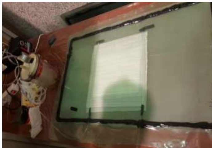
شکل ۶- بستن کیسه خلأ بر روی الیاف‌های چیده شده
