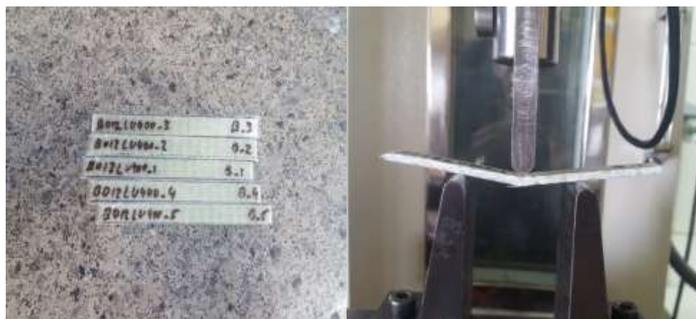
شکل ۱۳- نمونه‌ها و آزمون خمش سه نقطه
