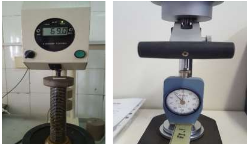
شکل ۱۴- آزمون Shore D سمت راست و آزمون Rockwell سمت چپ
