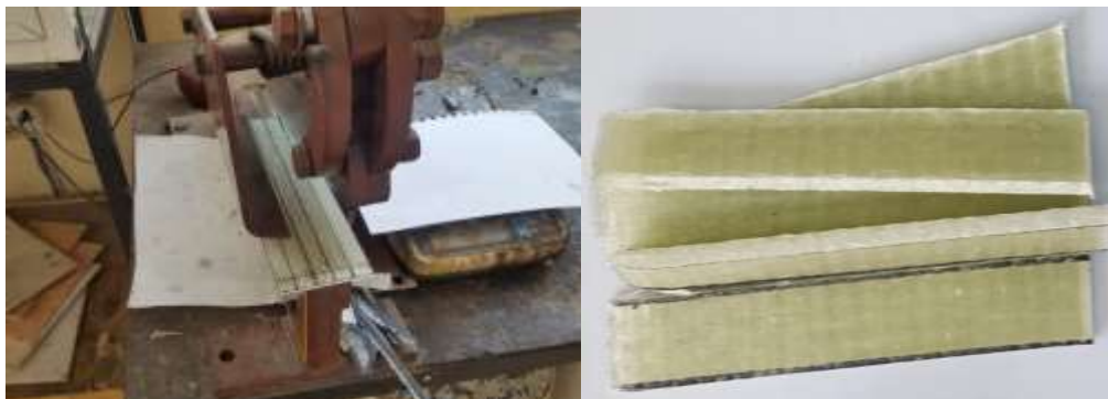
شکل ۱۱- برش ورق‌ها و آماده شدن نمونه‌ها
