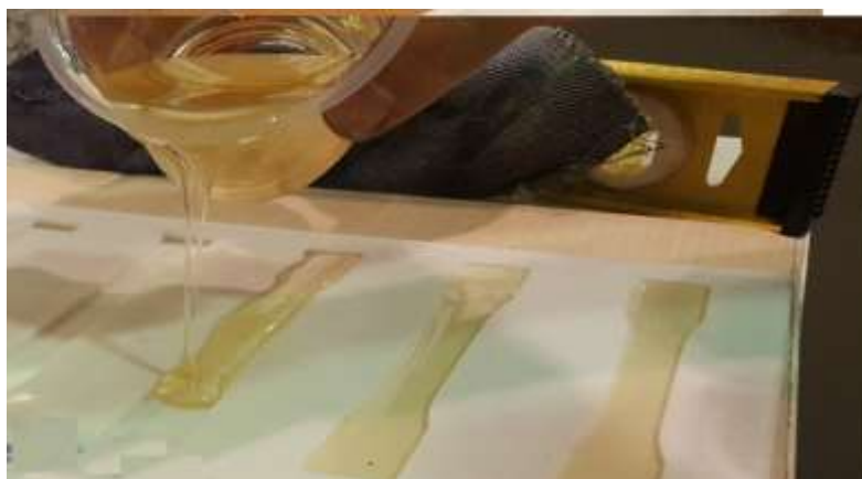
شکل ۹- ریختن رزین در قالب سیلیکون
