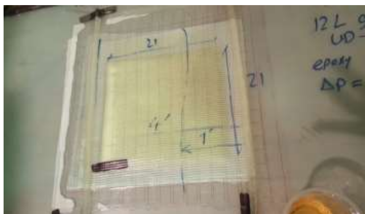
شکل ۸- مراحل تزریق رزین توسط خلأ
