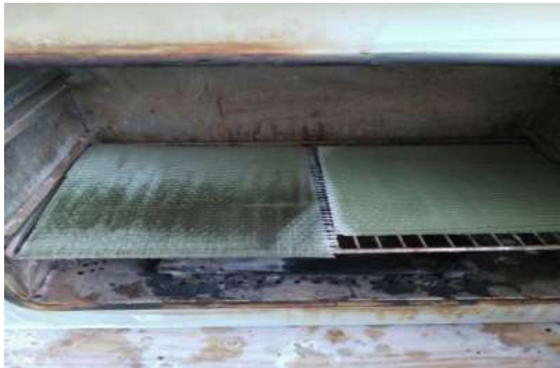
شکل ۱۰- پخت ورق‌های کامپوزیتی و نمونه‌های رزین خالص در کوره
