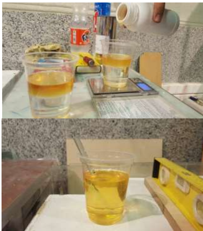
شکل ۷- اختلاط اجزاء رزین و شکل گیری رزین
