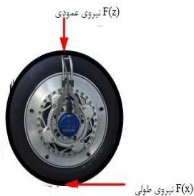
شکل ۳ ب- اندازه‌گیری نیروی طولی و عمودی
