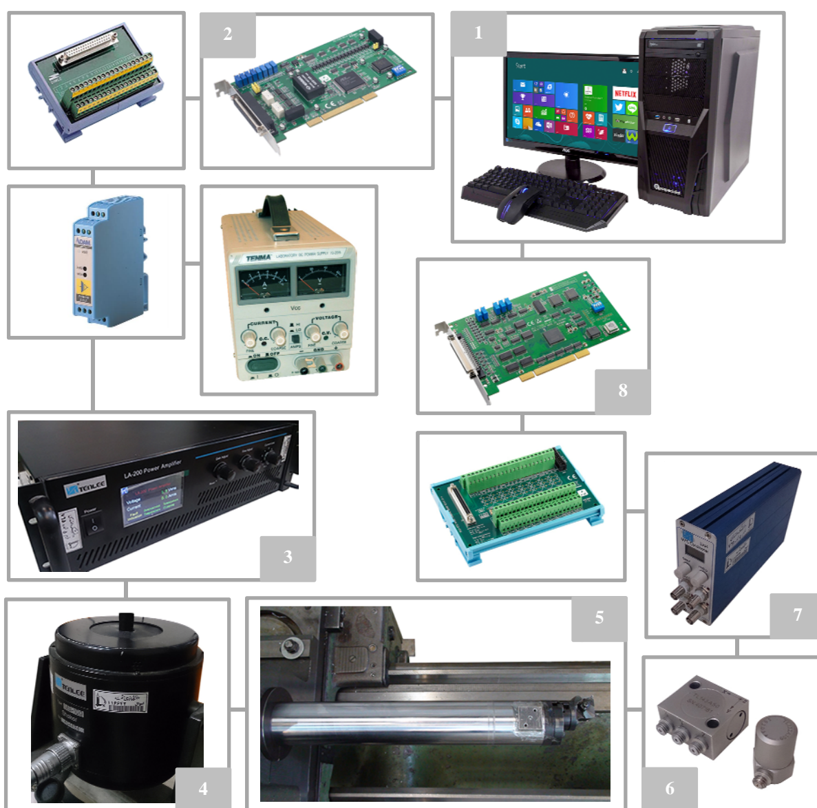
شکل ۱- اجزاء سخت افزاری تشکیل‌دهنده بستر آزمایشگاهی در این تحقیق.
