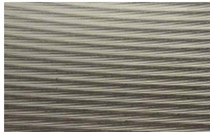
شکل ۳- بافت سطح قطعه‌کار در آستانه بروز ناپایداری دینامیکی در فرآیند برش.
