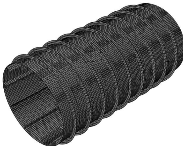
شکل ۸- نمایی از پوسته تقویت شده مش زده شده در اتصال از نوع جوش
