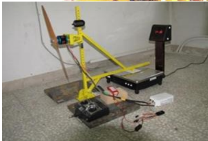
شکل ۱۳- تست استند جهت آزمایش تراست استاتیکی
