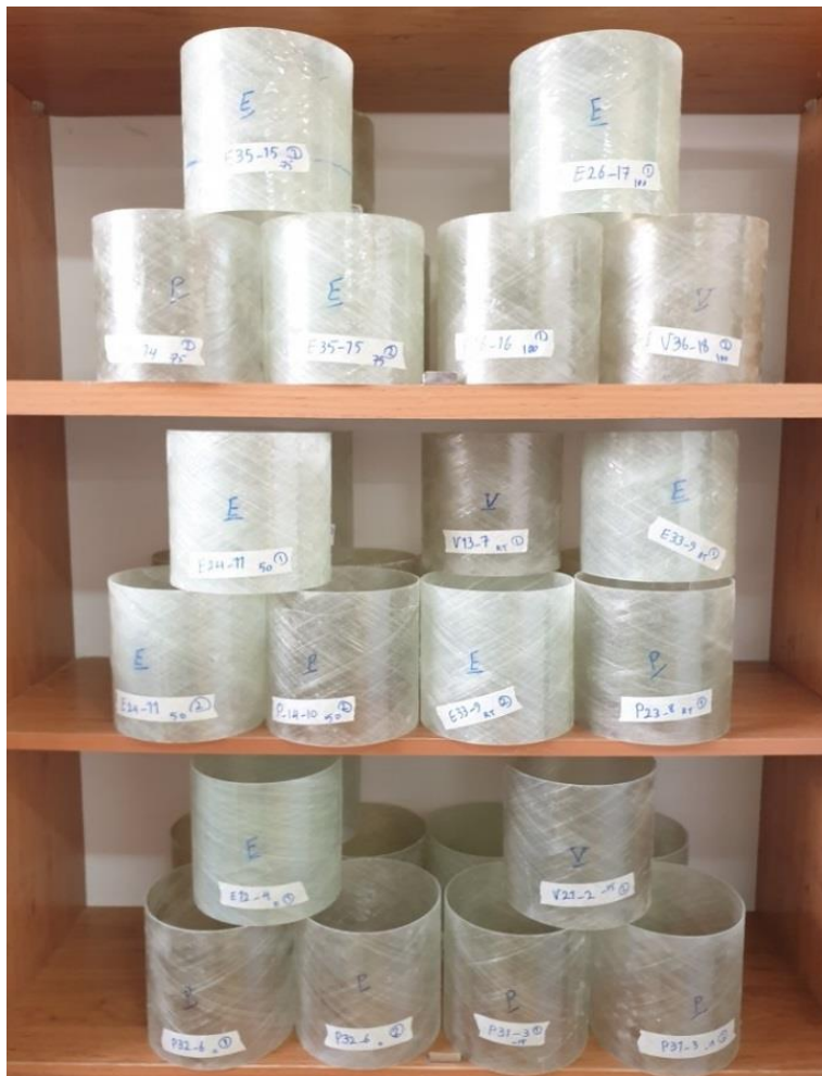
شکل ۱- نمونه‌های تولیدی با رزین‌های مختلف بر اساس طراحی آزمایش تاگوچی
