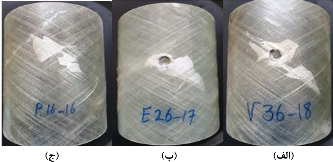
شکل ۱۰- نمونه‌ها پس از آزمایش ضربه در دمای ۱۰۰ درجه سانتیگراد با رزین (الف) پلی استر (ب) اپوکسی (ج) ونیل استر و انرژی ضربه به ترتیب ۱۰، ۲۰ و ۳۰ ژول
