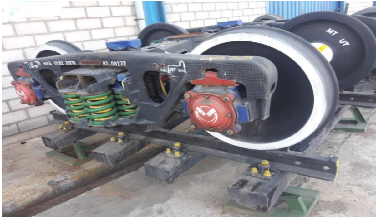
شکل ۱- نمونه‌ای از بوژی یک واگن باری
