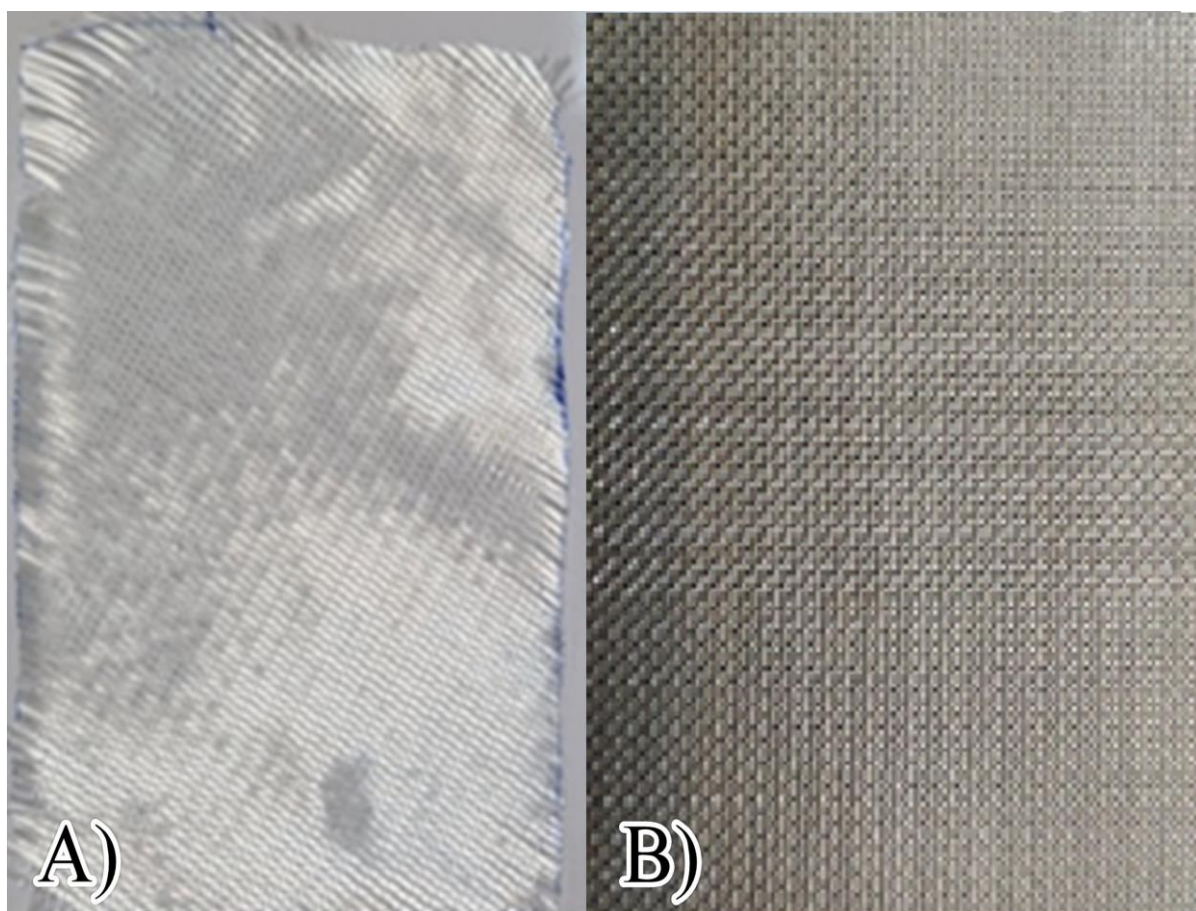
شکل ۱- نمونه الیاف الف) شیشه و ب) فلزی مورد استفاده در ساخت پانل ساندویچ
