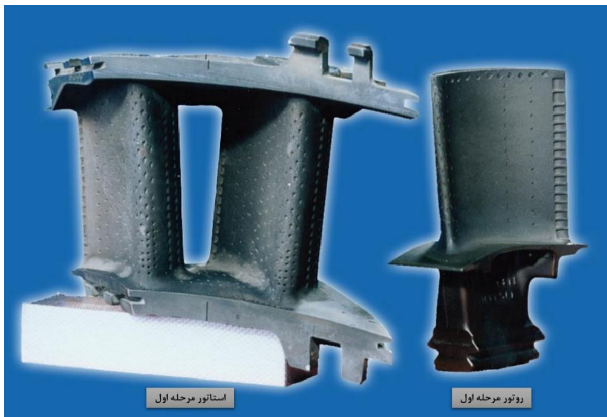
شکل ۲- نمایی از پره‌های روتور و استاتور مورد استفاده در موتور F100-PW-220 [۵]
