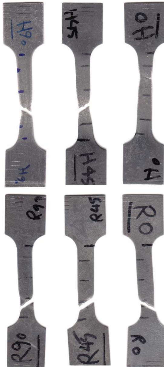
شکل ۴- تصاویر نمونه‌های تیتانیوم خالص نورد شده و نورد شده با آنیل پایانی بعد از انجام آزمایش کشش که شکست نمونه‌ها در راستای 45^\circ نسبت به راستای اعمال نیروی کشش را نشان می‌دهند.
