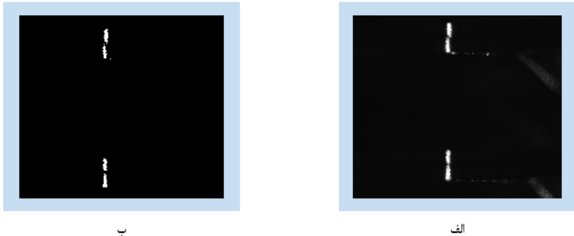
شکل ۶- تأثیر استفاده از الگوریتم‌های مورفولوژی؛ (الف) تصویر اصلی گرفته شده با سیستم بینایی، (ب) تصویر پردازش شده بعد از اعمال الگوریتم‌های مورفولوژی
