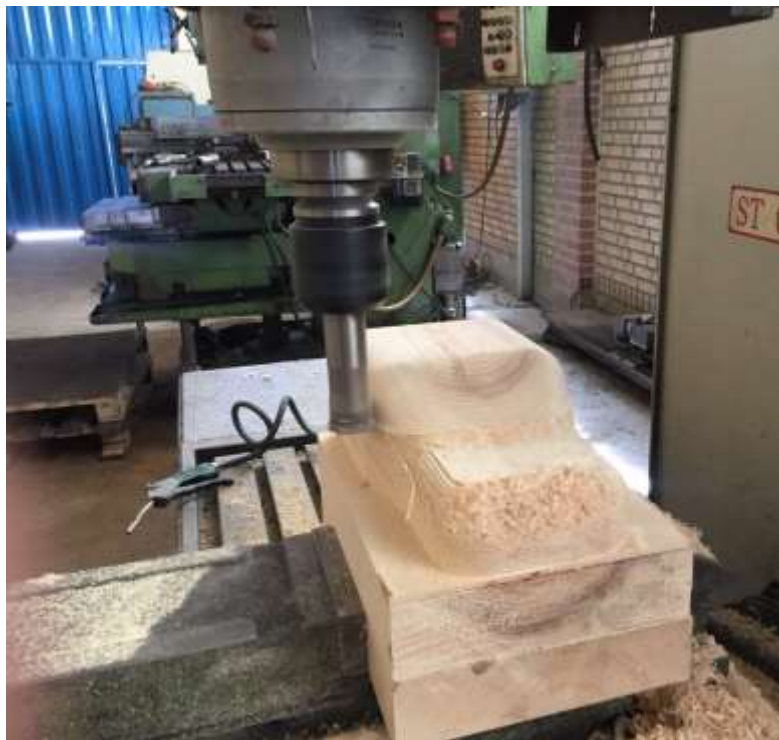
شکل ۴- ساخت بدنه مدل با استفاده از دستگاه تراشکاری
