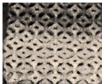
قبل از بارگذاری شروع بارگذاری و فشرده شدن تدریجی سلول‌ها ادامه فشرده شدن سلول‌ها
