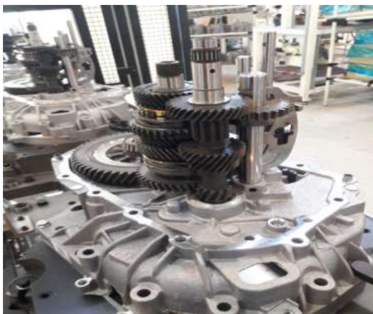
شکل ۴- نمای داخل گیربکس سواری تندر ۹۰
