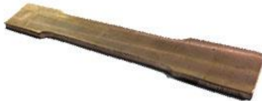
شکل ۳- نمونه مسی تست کشش
