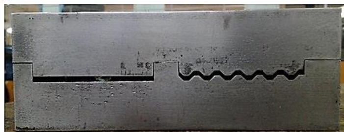
شکل ۲- ابعاد و تصویر قالب برای نمونه‌های به ضخامت ۳ میلی‌متر
